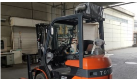
フォークリフトにスポットクーラーを取り付け（千葉工場）
